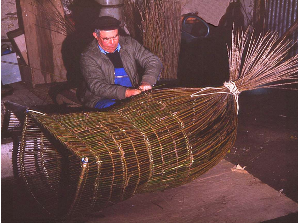
Un pêcheur aux engins fabriquant une nasse à lamproie en osier à Anetz ( Edmont Berthelot, 1998)...
